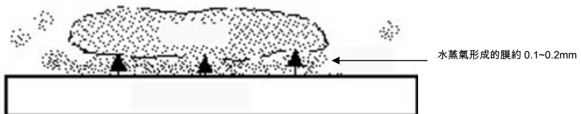
(圖二 攝氏 200 度左右熱盤上的水滴)
